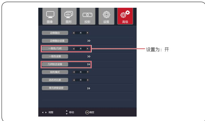
进入几何校正, 对图像进行8点校正。
